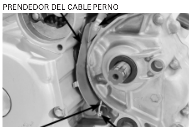
CABLE INTERRUPTOR DEL PUNTO MUERTO PRENDEDOR DEL CABLE PERNO
