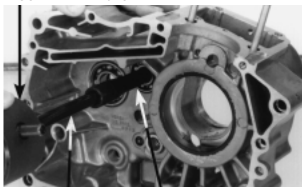
EXTRACTOR DE RODAMIENTO
