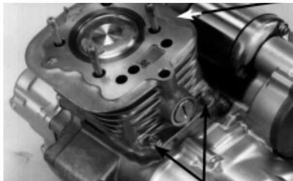
PERNOS DE FIJACIÓN DEL CILINDRO
