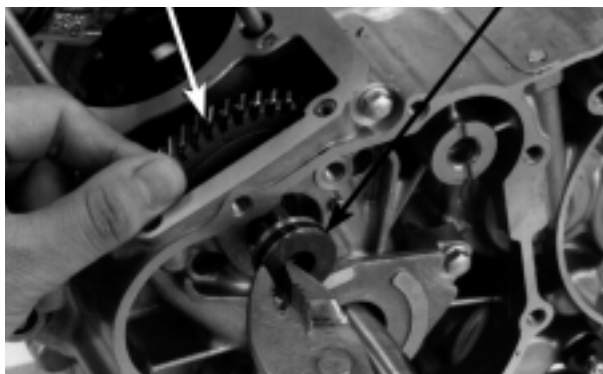
RESORTE DEL ARBOL DE LEVAS EJE DEL ENGRANAJE DE DISTRIBUCIÓN
