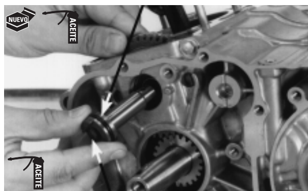
EJE DEL ENGRANAJE DE DISTRIBUCION
