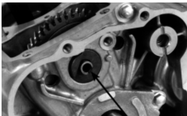
RESORTE DEL ARBOL DE LEVAS EJE DEL ENGRANAJE DE DISTRIBUCIÓN
