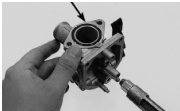
TORNILLO DE TOPE DEL PISTON DE ACELERACION/ANILLO TORICO/RESORTE CAJA DEL ACELERADOR
