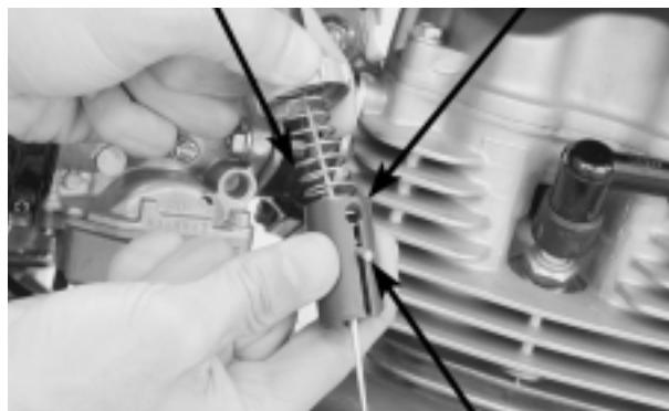
CABLE DEL ACELERADOR RANURA VALVULA DE ACELERACIÓN
