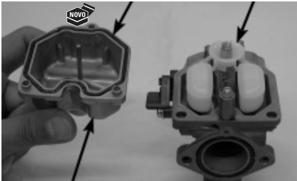
CUBETA DEL FLOTADOR
