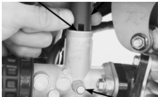
TORNILLO DE TOPE DEL PISTÓN DE ACELERACIÓN
