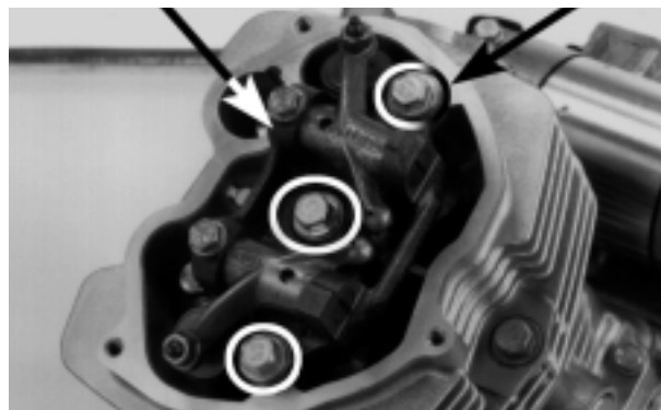
CONJUNTO DEL SOPORTE DEL BALANCIN
