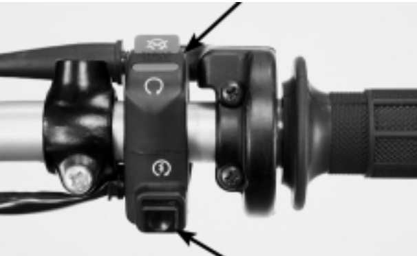
INTERRUPTOR DE ARRANQUE (solamente tipo ES)
