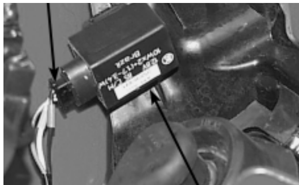
RELÉ DEL INTERMITENTE DE DIRECCIÓN
