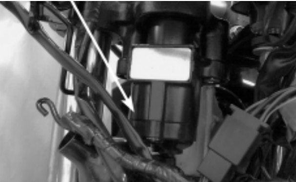
INTERRUPTOR DE ENCENDIDO
