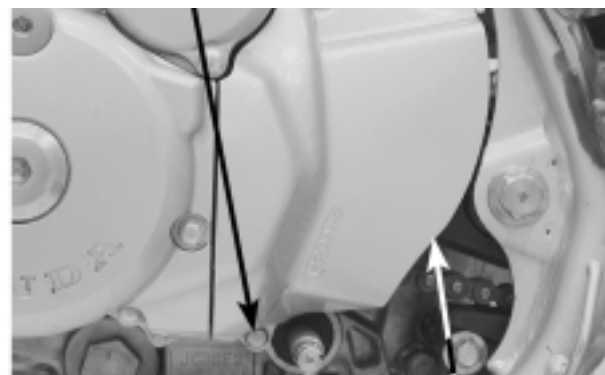
TAPA DE LA RUEDA PROPULSORA DE TRANSMISIÓN VARILLA DEL FRENO
