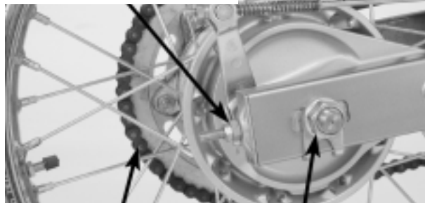
CADENA DE TRANSMISIÓN RUEDA PROPULSORA DE TRANSMISIÓN
