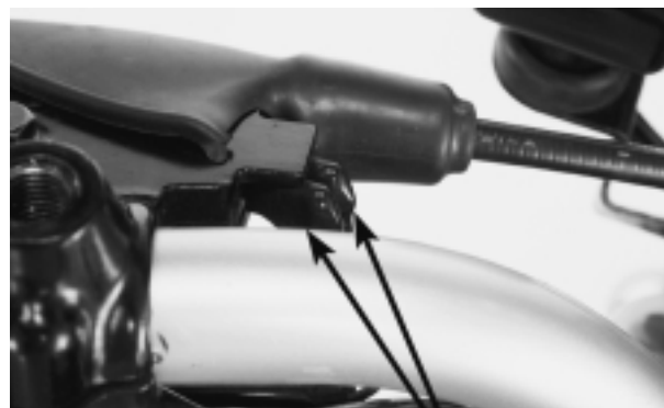
ENCHUFES DEL INTERRUPTOR DEL EMBRAGUE
