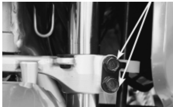
PERNO SUPERIOR DE LA HORQUILLA
