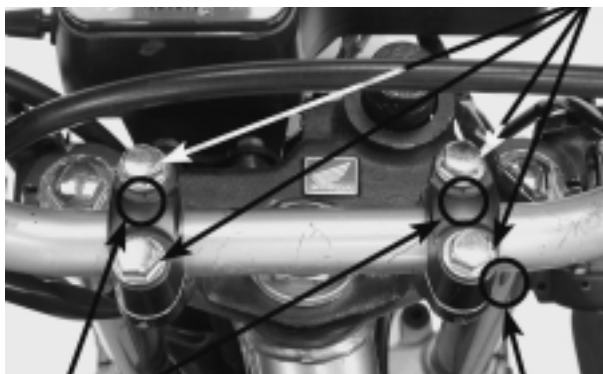
MARCAS DE PUNZÓN DEL SOPORTE SUPERIOR
