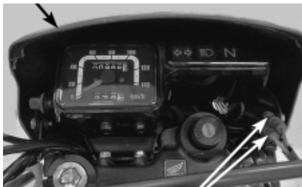
ENCHUFES DEL INTERRUPTOR DE LA LUZ DEL FRENO ESPEJOS RETROVISORES
