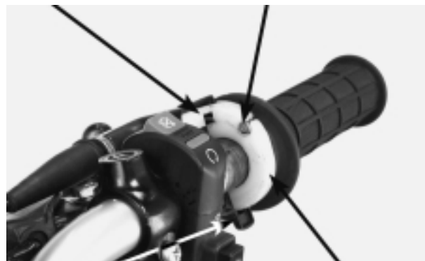
SOPORTE DEL ACELERADOR TUBO INTERIOR DE LA EMPUÑADURA DEL ACELERADOR
