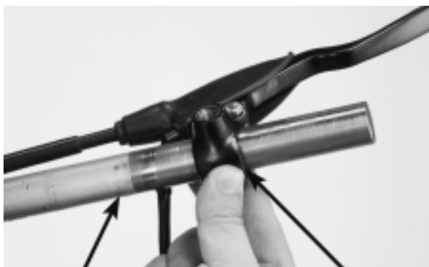
MANILLAR SOPORTE DE LA PALANCA DEL FRENO PERNOS DE LOS SOPORTES DEL MANILLAR
