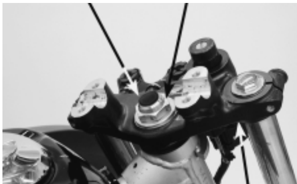
PUENTE SUPERIOR TUERCA DE AJUSTE DE LA COLUMNA DE DIRECCIÓN
