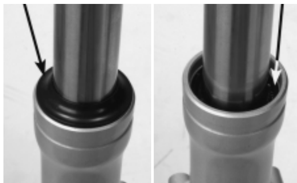
ARANDELA TÓRICA GUARDAPOLVO PERNO ALLEN ANILLO LIMITADOR
