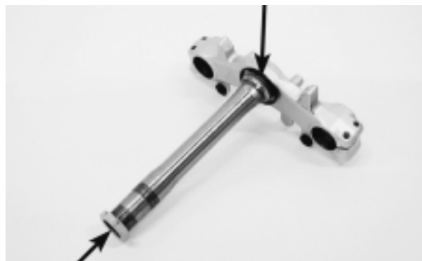
TUERCA DE LA COLUMNA DE DIRECCIÓN
