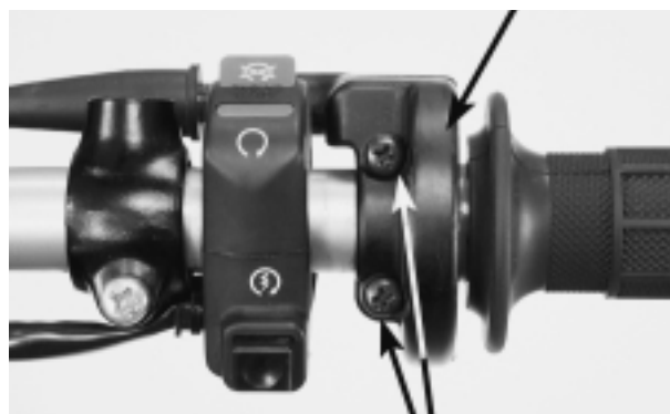
GUÍA DEL CABLE DEL ACELERADOR PERNOS EXTREMIDAD DEL CABLE DEL ACELERADOR
