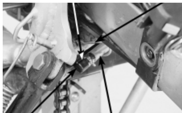
TAPÓN DE LA MANGUERA DE DRENAJE DEL RESPIRADERO MANGUERA DE DRENAJE DEL RESPIRADERO
