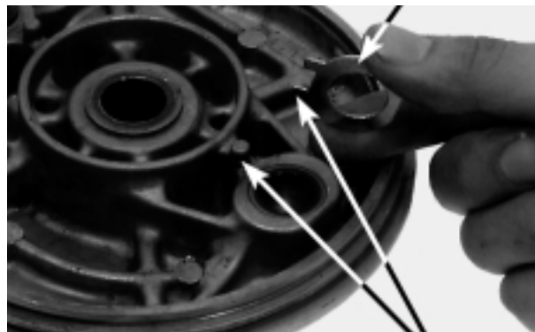
ALINEAR LEVA DEL FRENO
