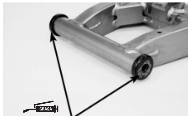
CAPAS DE LOS GUARDAPOLVOS DEL BRAZO OSCILANTE
