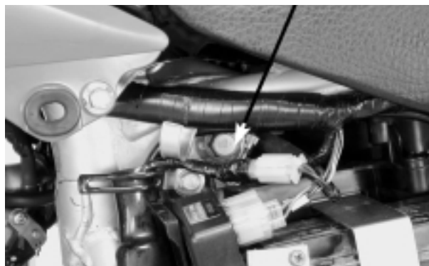
TORNILLO DE FIJACIÓN SUPERIOR DEL AMORTIGUADOR
