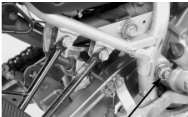
TORNILLO/TUERCA DE LA ARTICULACIÓN DEL BRAZO OSCILANTE
