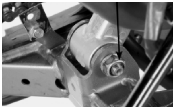
TORNILLO/TUERCA DE FIJACIÓN INFERIOR DEL AMORTIGUADOR
