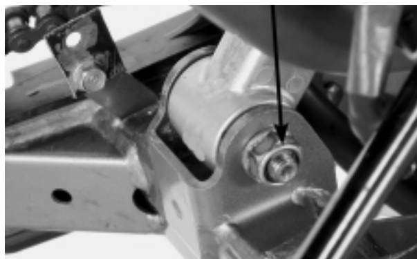
TORNILLO/TUERCA DE FIJACIÓN INFERIOR DEL AMORTIGUADOR
