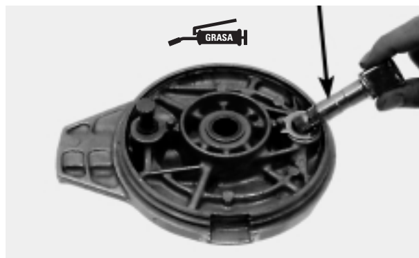
ALINEAR LEVA DEL FRENO
