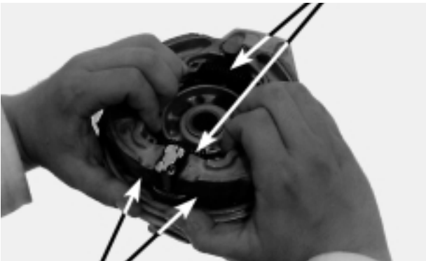
ZAPATAS DEL FRENO BRAZO DEL FRENO
